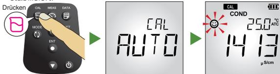
4. Drücken Sie die ENT-Taste, um die Leitfähigkeitsmessung zu bestätigen. Drücken Sie die MEAS-Taste, zum Abbrechen der Kalibrierung.
